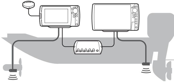
**REMARQUE :** Cet accessoire peut seulement être utilisé avec les têtes de commande Humminbird dotées d'une fonctionnalité Ethernet. Contactez le support technique sur le site Web [humminbird.com](http://humminbird.com) ou appelez le **1-800-633-1468** pour plus d'informations.
